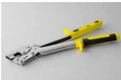
IMPIEGO: per un rapido assemblaggio di montanti e guide. Si usa con una sola mano. Spessore max. fissabile 1,4 mm.
