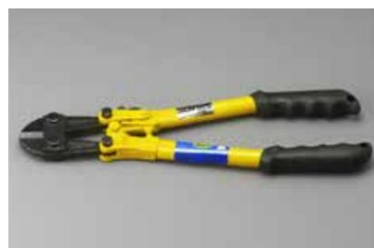
IMPIEGO: dimensione ridotta lunga solo 30 cm, taglia fino ad un massimo di 4 mm. Peso 250 gr. Si usa con una sola mano. Per il taglio di pendini  $\varnothing 2$ ,  $\varnothing 3$ ,  $\varnothing 4$  mm. Taglio preciso, pratico e veloce.
