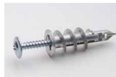
IMPIEGO - NOTE: specifico per fissaggi su pareti e controsoffitti in cartongesso. Tenuta massima garantita a taglio 40 kg. Tenuta massima garantita a soffitto 3/5 kg. Tassello autoperforante da inserire sulla lastra con un normale inserto Phillips n° 2 tramite un avvitatore.
