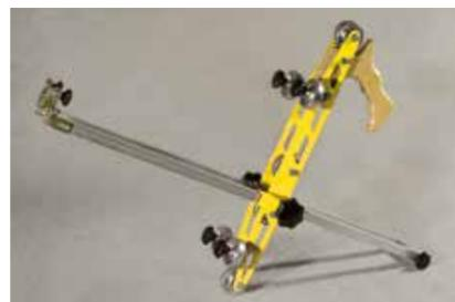
IMPIEGO: in acciaio cromato. Impugnatura ergonomica. In una sola operazione traccia e taglia strisce di lastra in cartongesso da 6 a 15 mm di spessore e 60 cm max di larghezza. Monta normali lame larghe 18 mm.
