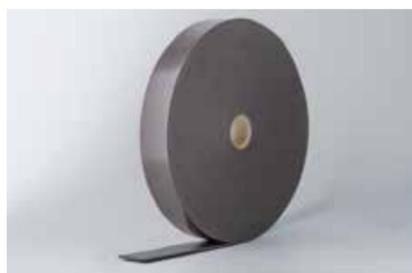
**IMPIEGO - CARATTERISTICHE TECNICHE:** guarnizione adesiva di tenuta all'aria, alla polvere, all'acqua, ai rumori, ecc. (da applicare sotto/sopra alla guida per le pareti divisorie). Specifico per l'abbattimento acustico, in resina di polietilene impermeabile e imputrescibile, non tossico; densità 32 kg/m<sup>3</sup>. Adesivo: acrilico a base acqua.
