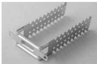
IMPIEGO: per fissare profili a parete. Per la correzione del “fuori piombo”; utilizzo per montanti larghi 50 o 60 mm. Acciaio zincato.
