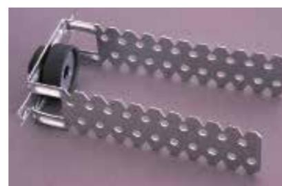
IMPIEGO: per fissare profili a parete. Per la correzione del "fuori piombo"; utilizzo per montanti larghi 50 o 60 mm. Per la posa di contropareti insonorizzate e antivibranti. In acciaio zincato.
