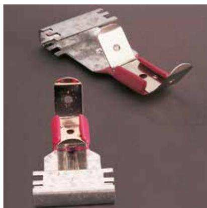
**IMPIEGO:** specifico per la posa di controsoffittature antivibranti e insonorizzate. Dotato di doppio aggancio. Compatibile sia per profili con bordi schiacciati sia con bordi arrotondati. Corpo acciaio zincato - molla acciaio temperato C70 nichelata.
