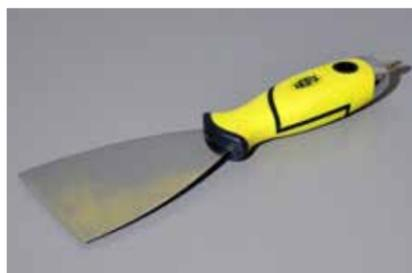
IMPIEGO: per una perfetta posa e copertura dei nastri d'armatura dei giunti. La parte superiore del manico è dotata di una cavità dove è posizionato e incassato un inserto Philips n° 2, utilizzabile qualora si trovassero durante la stuccatura delle viti sporgenti.
