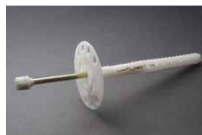
**IMPIEGO:** fissaggio per pannelli di sistemi di isolamento termico esterno (ETICS) su mattone pieno e vuoto e calcestruzzo leggero. Fissaggio a percussione ad alte prestazioni. Utilizzabile a parete e a soffitto. Perno non assemblato all'interno del corpo del tassello.
