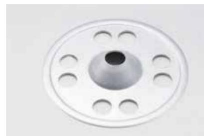
IMPIEGO: rondelle con foro svasato internamente, per cui il tassello applicato ad esse non fa spessore all'esterno. Per viteria da NF06100 a NF06126, per tasselli NF08 - NF11 e tasselli con diametro Ø 6 mm e Ø 8 mm.
