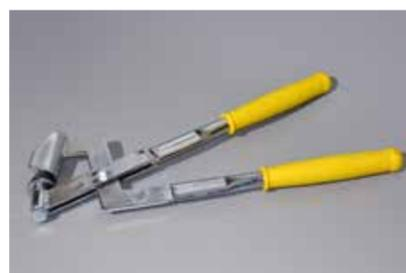
IMPIEGO: il foro prodotto ha un diametro di 25 mm. Per forare i montanti in lamiera zincata in maniera pratica, veloce e senza deformare il profilo consentendo il passaggio delle guaine per cavi elettrici o idrauliche.
