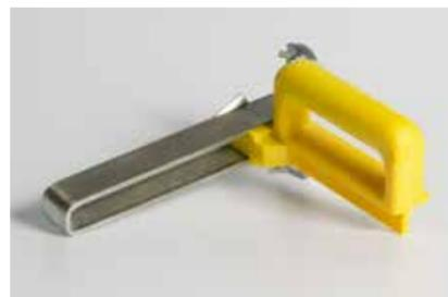
IMPIEGO: impugnatura perfetta ed ergonomica. Capace di tagliare la lastra in maniera perfetta fino a un massimo di 20 cm ed uno spessore da 9,5 a 15 mm. Per il taglio netto e preciso della lastra in cartongesso.
