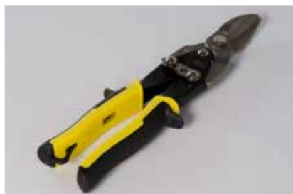
IMPIEGO: leva demoltiplicata. Lama al cromo-molibdeno. Manici ergonomici in ABS con inserti gommati Soft-Grip per una presa perfetta. Per il taglio del profilo in lamiera zincata.
