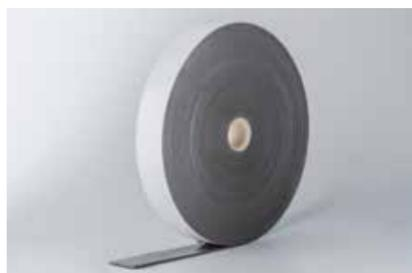
**IMPIEGO - CARATTERISTICHE TECNICHE:** nella posa in opera di pareti divisorie, per fissaggio delle guide alla pavimentazione (ove necessita non forare). Per un'azione combinata di rapido fissaggio e abbattimento acustico, in resina di polietilene impermeabile e imputrescibile, non tossico; densità: 32 kg/m<sup>3</sup>. Adesivo: acrilico a base acqua.
