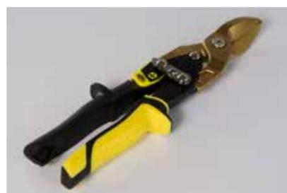
IMPIEGO: leva demoltiplicata. L'innovativa lama al cromo-molibdeno rivestita in titanio facilita il lavoro di taglio e garantisce una maggior durata dell'utensile. Manici ergonomici in ABS con inserti gommati Soft-Grip per una presa perfetta. Per il taglio del profilo in lamiera zincata.
